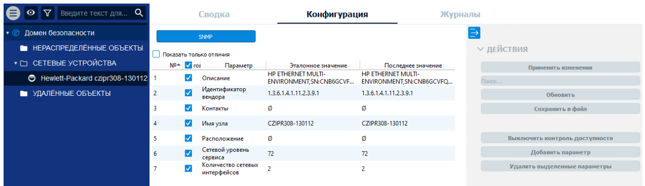
Рис. 266. Отображение значений параметров сетевого оборудования на вкладке «Конфигурация»
